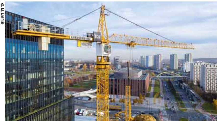
Żuraw Liebherr 132EC-H Litronic i wieża drugiego żurawia 230HC-L8/16 Litronic na prestiżowej budowie KTW II
